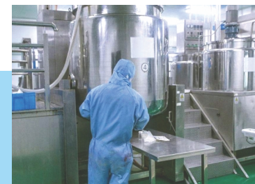
药品加工槽罐清洗
