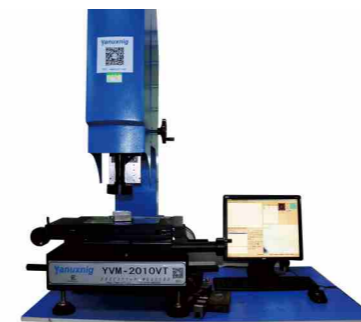
二次元测量仪 用于小孔等精密尺寸检测
