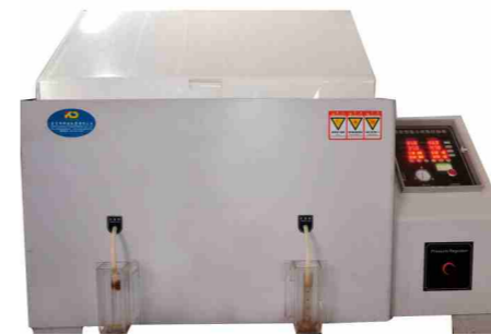
盐雾测试机 用于原材料等腐蚀性能检测
